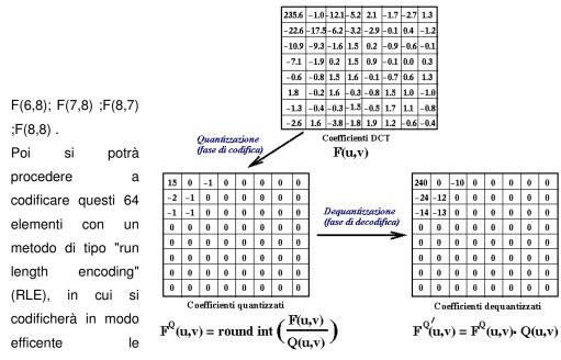
sequenze di zeri. Il primo elemento dei 64 viene chiamato coefficente DC e viene codificato nel seguente modo: per ridurre il coefficente DC, che di solito è un numero abbastanza elevato, si prende il DC del blocco precedente (DCprec) e lo si sottrae a quello del blocco corrente (DCcorr), si otterrà il seguente numero (DCdiff):
